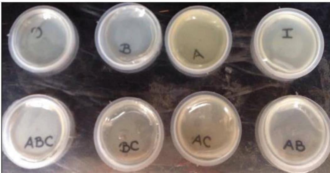
**Figura 3.7.** Láminas de emulsiones VAc-VeoVa después de transcurrido el tiempo de secado (48 h) a una temperatura de 50 °C
